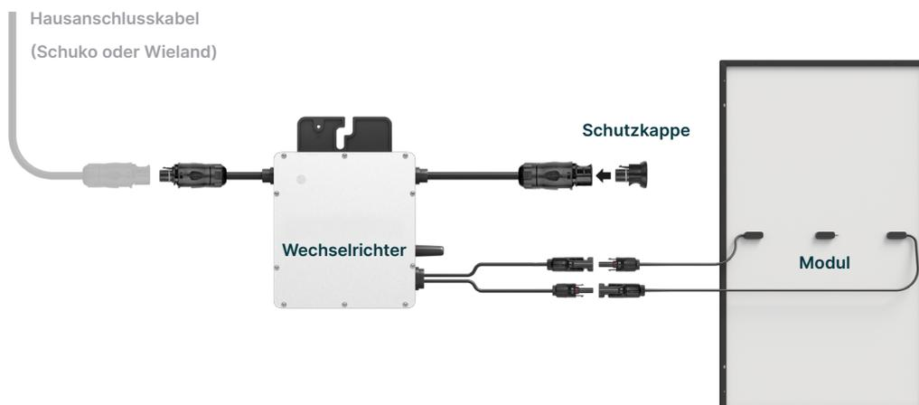
Anschlussplan für **2** Module + **1** Wechselrichter:
