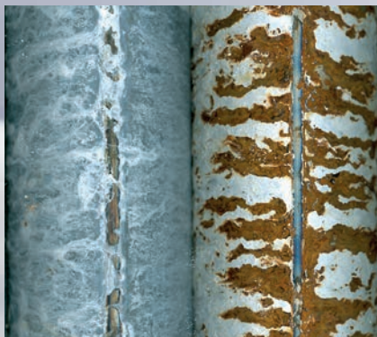
Magnelis® ZM120 feuerverzinkt Z275 geschweißt, nicht nachbehandelt zyklischer Korrosionstest (3CT) (VDA 621-415) nach Testzeitraum von 33 Wochen
