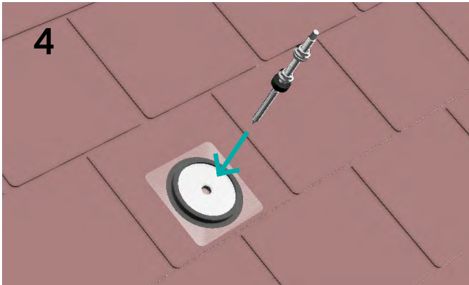
Stockschraube in Sparren schrauben
