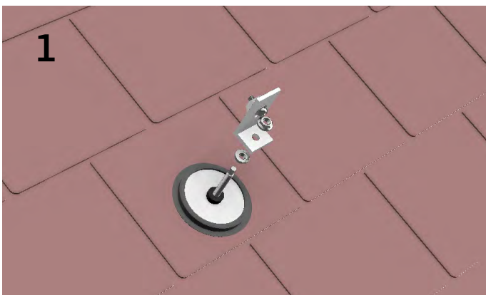
Klemmvorrichtung auf Stockschraube platzieren
